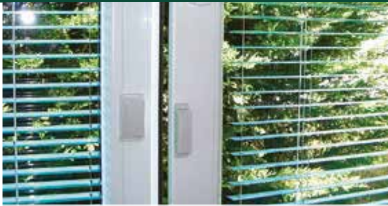
Seguridad con interruptor magnético inalámbrico
